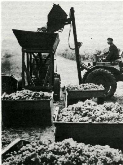
Рис. 2. Погрузка винограда при помощи агрегата виноградникового навесного
